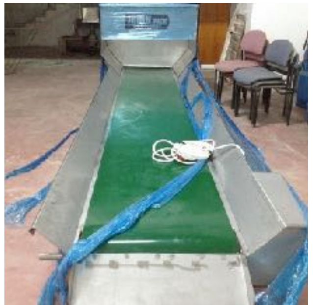
Tapis d'évacuation des déchets
