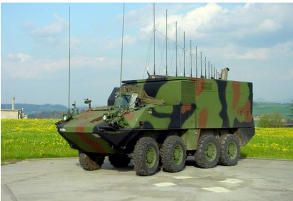
*véhicule avec émetteur à usage multiple ESM*
